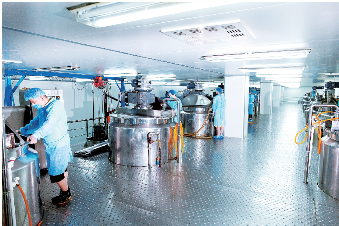
工人把植物提取液浓缩成植物洗头原浆。
